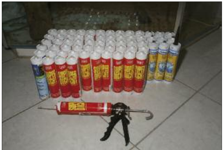
Der Materialverbrauch für den Bau des Aquaterrariums war beträchtlich. So wurden über 70 Kartuschen Silikon verarbeitet, weiterhin 6 kg Elastopur, 13 kg Epoxidharz, über 16 m 2 Glas, ca. 24 m Aluprofile, rund 40 m Elektrokabel, 20 m Steuerkabel, sechs Steckdosenleisten und noch vieles mehr.
