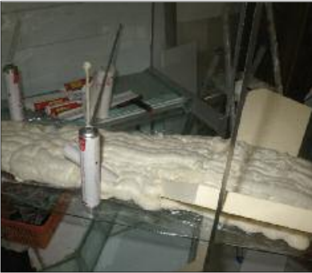
Aus PU-Montageschaum wurde in mehreren Arbeitsgängen ein „Baumrohling“ auf eine mit Folie bedeckte Platte gesprüht. In den noch weichen Schaum gesteckte Hartschaumplatten wurden später zu „Brettwurzeln“ und „Ästen“ geschnitzt. Durch eine mehrlagige Epoxydharzbeschichtung mit Korkstaubbeflockung wurde aus dem PU-Rohling nach und nach ein künstlicher „Regenwaldbaum“.
