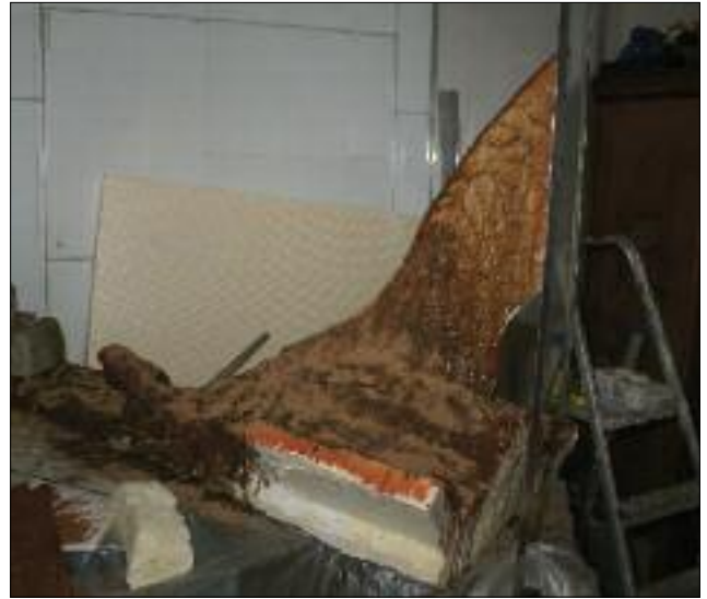
Aus PU-Montageschaum wurde in mehreren Arbeitsgängen ein „Baumrohling“ auf eine mit Folie bedeckte Platte gesprüht. In den noch weichen Schaum gesteckte Hartschaumplatten wurden später zu „Brettwurzeln“ und „Ästen“ geschnitzt. Durch eine mehrlagige Epoxydharzbeschichtung mit Korkstaubbeflockung wurde aus dem PU-Rohling nach und nach ein künstlicher „Regenwaldbaum“.
