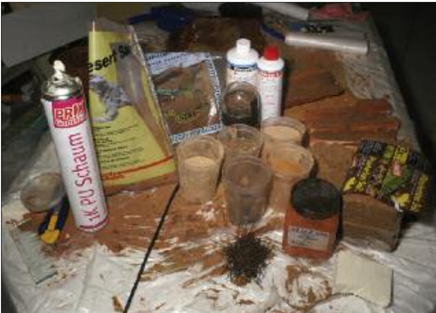
Epoxydharz, mineralische Farbpigmente, Sand und feiner Kies sowie Korkstaub, Torfmull, Xaxim-Mehl und gemahlene Kokosfaserstücke wurden für die Beschichtung der Rück- und Seitenwände aus Polyurethanschaum verwendet
